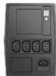
ИБП 1000 ВА, вид сзади
