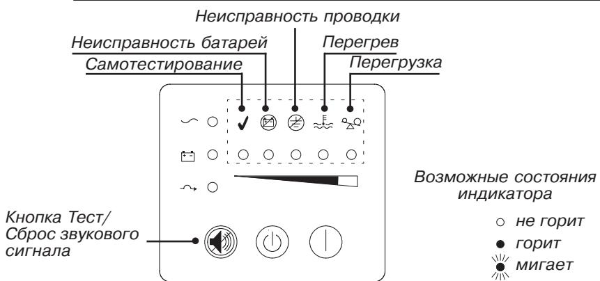
Рисунок 39. Индикаторы неисправности
