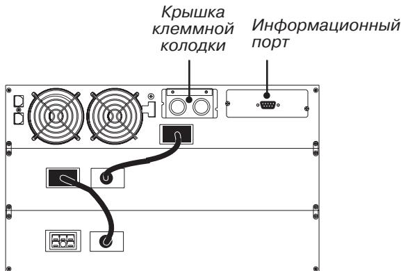
**Рисунок 17. Пример фиксированного подключения ИБП**
