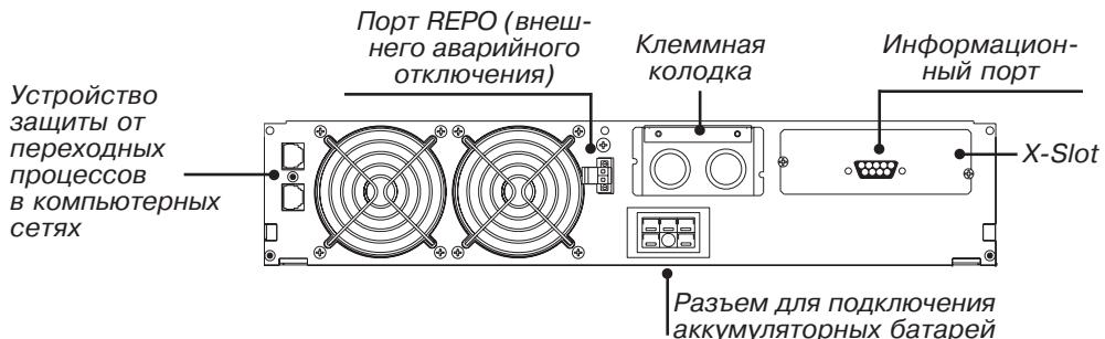
Рисунок 25. 2500/3000 ВА, 208–240В Задняя панель для фиксированного подключения
