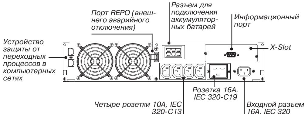
Рисунок 23. 2500/3000 ВА, 208В Задняя панель
