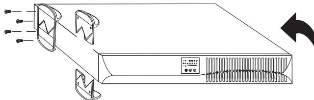
**Рисунок 4. Установка подставок на одиничный ИБП**
