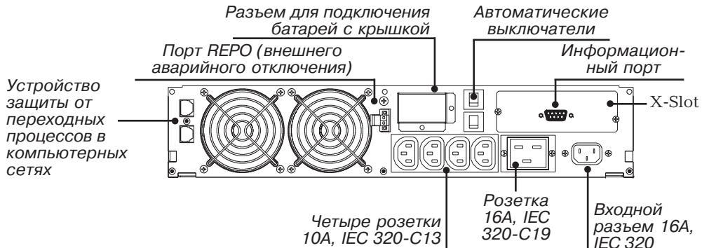
Рисунок 24. 2500/3000 ВА, 230В Задняя панель
