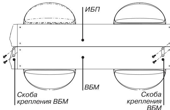
**Рисунок 10. Установка скоб крепления ВБМ (Вид сверху с подставками)**
