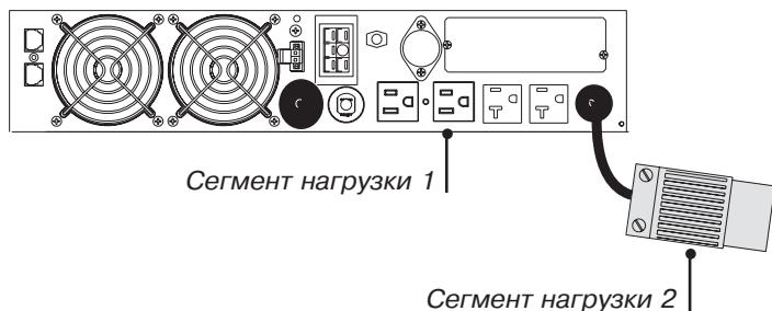
Рисунок 36. Сегменты нагрузки ИБП для моделей 120В
