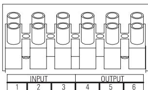
**Рисунок 19. Клеммная колодка**
