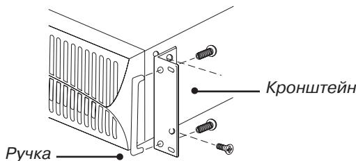
**Рисунок 2. Установка кронштейнов**
