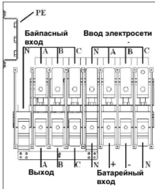
Рис. 2-18 Клеммная колодка ИБП 250/300кВА
