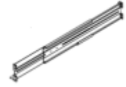
Правая направляющая для установки в стойку
