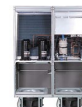
Установка вентиляторов под фальшполом уменьшает их потребляемую мощность на 20 % при таком же расходе воздуха
